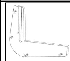
**Stap 1: Zet de schroeven in de zijpanelen**
